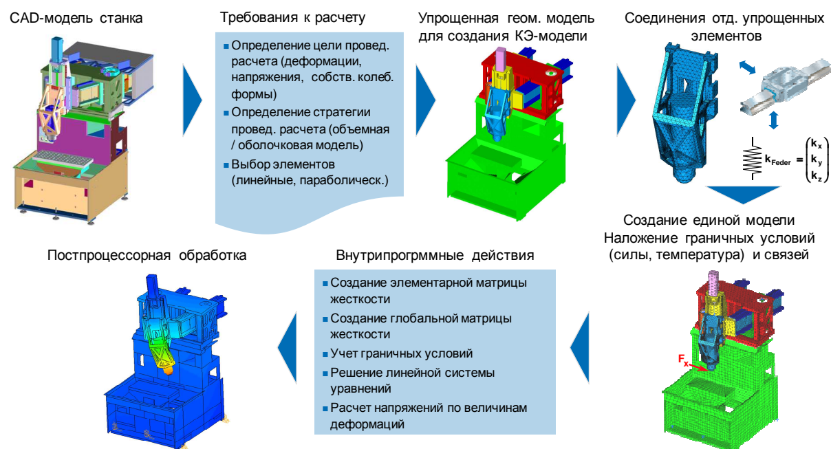
Рис. 4-2: Методика расчета с помощью МКЭ
