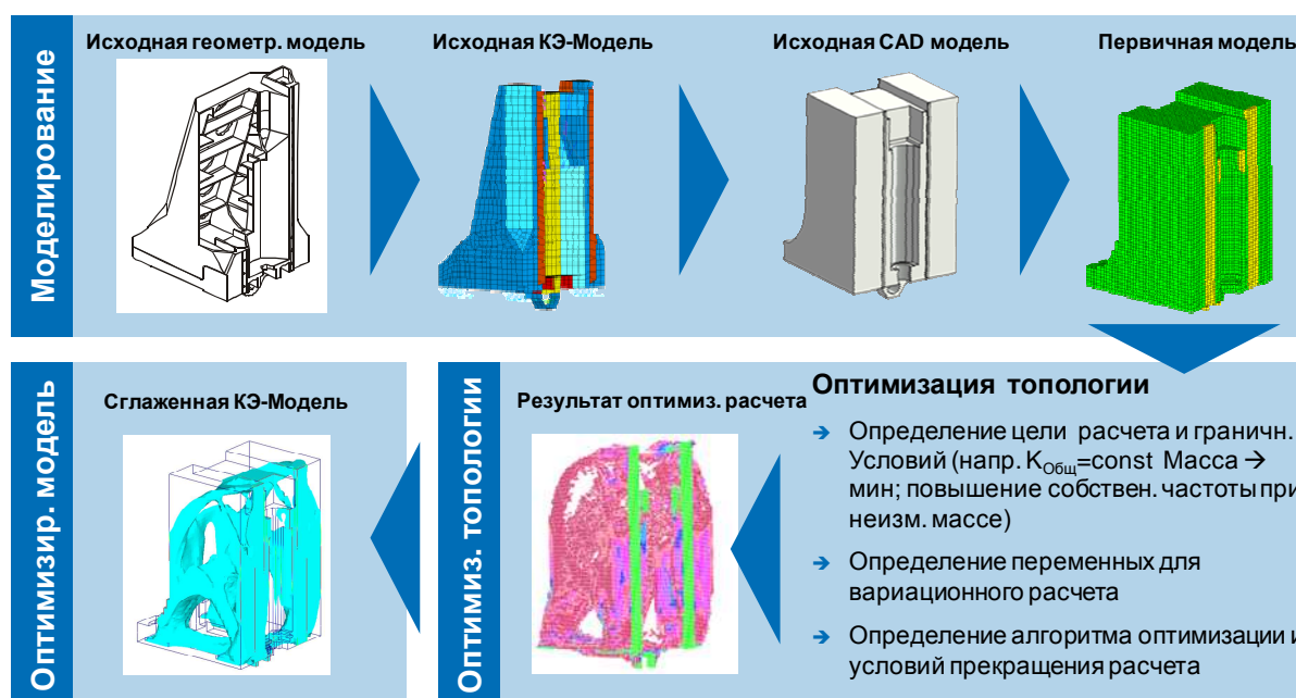
Рис. 4-23: Принцип оптимизации топологии
